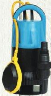
Zahradní elektrické čerpadlo Tesco XKS-451PW příkon 450 W, max. dopravní výška 6 m, max. průtok 9000 l/hod
