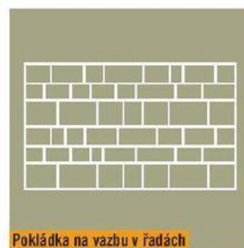
Pokládka na vazbu v řadách
